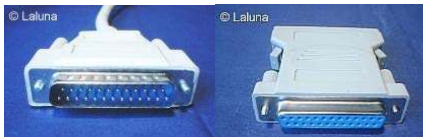
3-14. ábra: DB25 – D-Sub 25 pin csatlakozó
