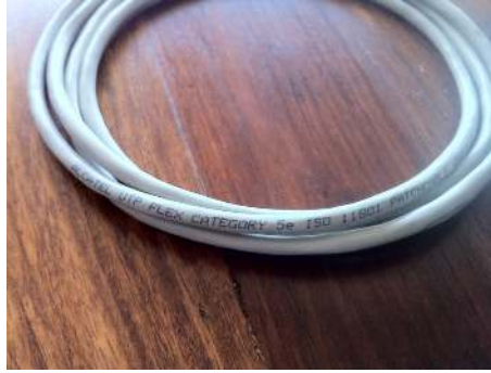
4. ábra. Egy UTP kábelén feltüntetett jelölések (többek között a kategória)
